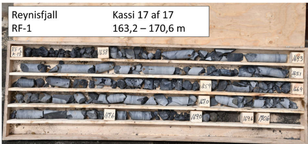
Mynd 10: Kubbaberg neðst í holu RF-1. Bergið lítur ekki vel út en kubbaberg er að jafnaði gott berg en raðast illa í kjarnakassa. Það lítur yfirleitt vel út þar sem það liggur í opnu kjarnarörinu þegar það kemur úr holunni, áður en það fer í kjarnakassann. Sú gæti verið raunin hér. Fyrirhuguð göng myndi liggja í kjarnabili frá 162 m og niður á 170 m dýpi í holunni.
