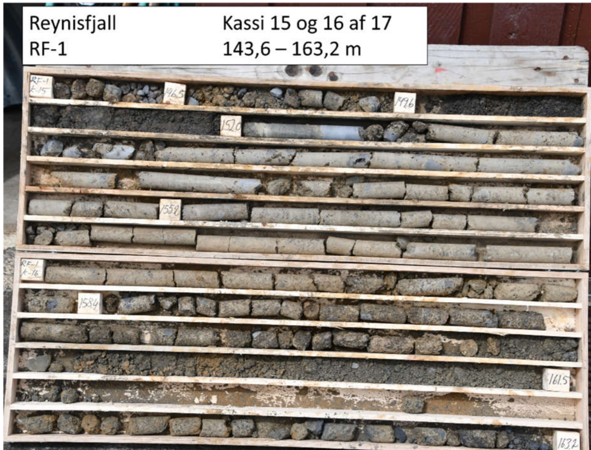
Mynd 9: Kjarni RF-1 frá 143-163 m dýpi, illa samliðd eða ósamliðd túffbreksía.
